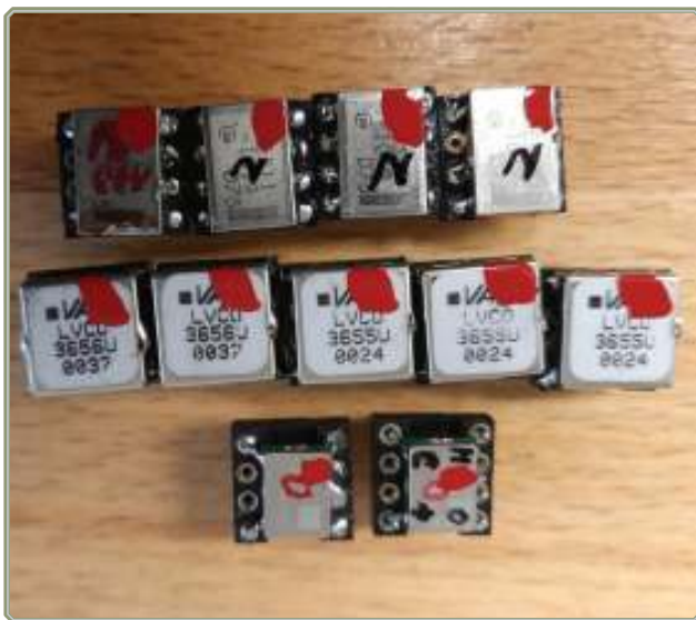
Nekaj preizkušenih VCO-jev, prispajkanih na 8 pinska podnožja
